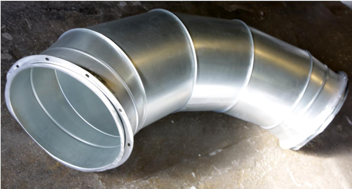
1. Для систем аспирации рекомендовано использовать только круглые воздуховоды. В прямоугольных воздуховодах снижается скорость, в углах накапливается пыль и мелкие частицы.
