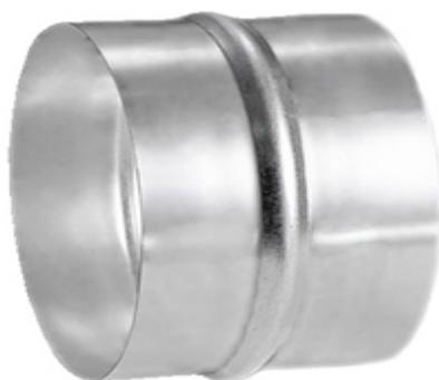
Ниппель применяется для соединения прямых участков систем воздухопроводов круглого сечения с равными диаметрами. Размер внешнего диаметра ниппеля соответствует размеру внутреннего диаметра трубопровода. Это упрощает монтаж системы вентиляции и обеспечивает ее герметичность. Особенности и преимущества ниппеля как соединяющего элемента в системе воздухопроводов в простоте использования, дешевизне и надежности крепления.
